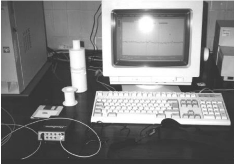
Fig. 1.- Equipo de instrumentación de BFB respiratorio: electrodo; codificador; almacén de datos; representación gráfica; teclado de ordenador.
